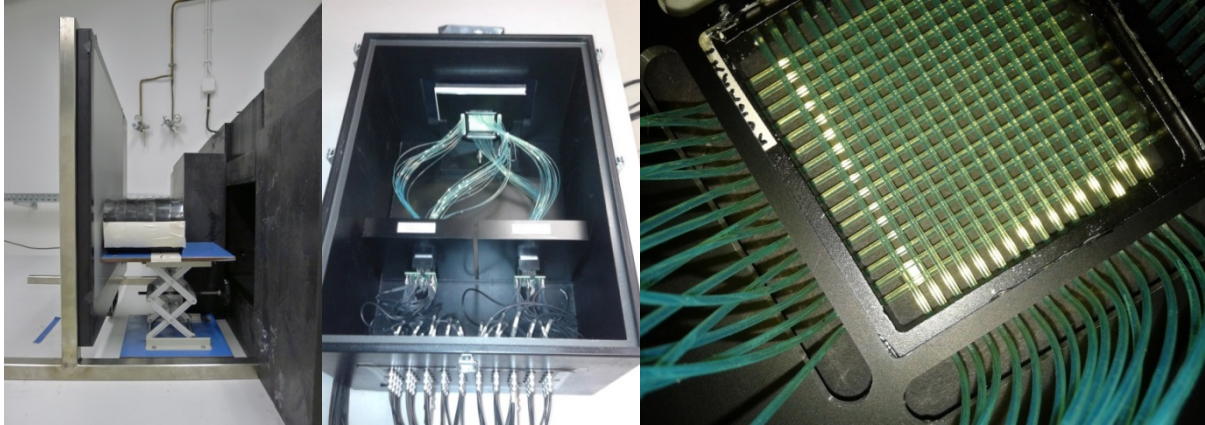
Abbildung 2: Auf dem linken Foto ist der experimentelle Aufbau mit dem aSi-Flat-Panel-Detektor (links) dargestellt. Hinter der schwarzen Öffnung (PE-Abschirmung) verbirgt sich die Neutronenquelle (DT-Neutronengenerator). Auf dem Objektisch befinden sich ein PE-Zylinder und ein Bleiblock (nicht zu sehen). Das mittlere und das rechte Foto zeigen den geöffneten WSF-Prototypen bzw. den Rahmen mit den wellenlängenschiebenden Fasern [Quelle: Manuel Schumann - FZJ].
